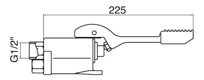
Cod. 0293 - Miscelatore a 2 pedali acqua calda e fredda per montaggio a pavamento
